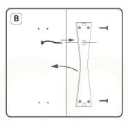
Coloque la base en la pared, asegurándose de pasar el cable de alimentación por el orificio central.
