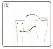
Realice la conexión eléctrica y coloque la luminaria sobre la base.
