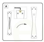
Retire los tornillos de la parte superior e inferior para desmontar la base de la Iuminaria
